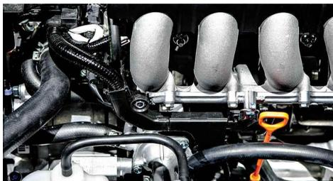
**11.** Rilsan® HT可取代金属，用来制造发动机零部件，这种聚酰胺耐高温并可减轻发动机重量。该材料的重量是：
