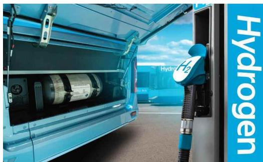
对于车载高压氢气的存储(700巴),现有标准储罐由热固性(环氧)树脂复合材料制成,经过挠曲工
