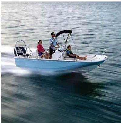
由玻璃纤维和Elium®树脂复合材料制成打造的船体。得益于Elium®的热塑性（该树脂可以加热和复原），这些部件在使用寿命结束后可完全回收利用，并且可在新船制造过程中再次利用。波士胶开发出了一款用于船舶组件装配的甲基丙烯酸甲酯结构胶
